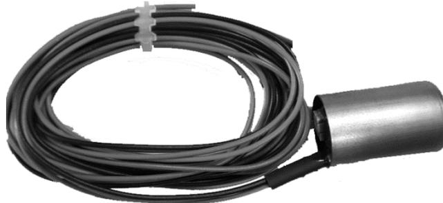
Der VOTRONIC D+ Simulator Pro (im folgenden D+ Simulator genannt) dient der Simulation eines D+ Signals bei Fahrzeugen mit Verbrennungsmotor, z.B. Reisemobile oder Sonderfahrzeuge.
